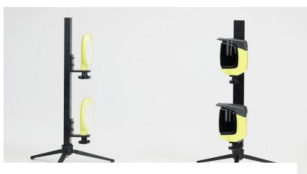
Σχήμα 3. Συστοιχία πυλών φωτοκυττάρων και ανακλαστήρων.
