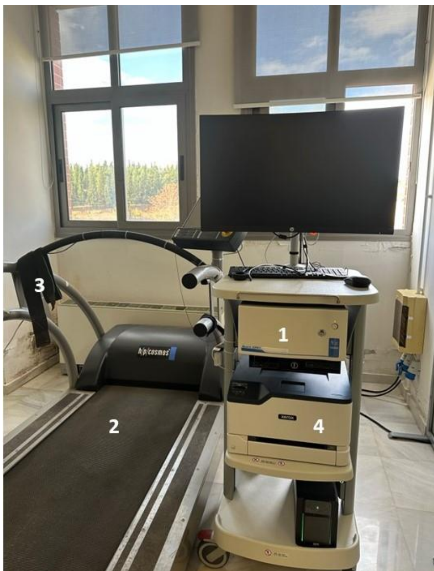
Εικόνα 1. Εργαστηριακός εξοπλισμός για τη μέτρηση της VO_2 . 1, εργοσπιρόμετρο· 2, δαπεδοεργόμετρο· 3, ζώνη μέσης· 4, εκτυπωτής.
